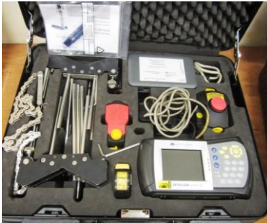
DB Pruftechnik Optalign Smart precision laser alignment
